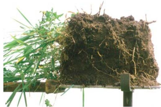
Spatenprobe gibt Aufschluss über den Bodenzustand
