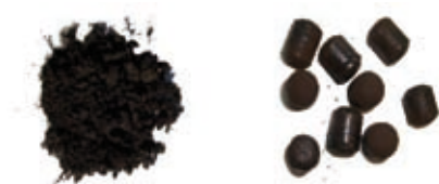
Abbildung 3-3: Aus Biomasse erzeugten Kohlepulver bzw. Kohlepellets (Quelle: Hydrocarb)
