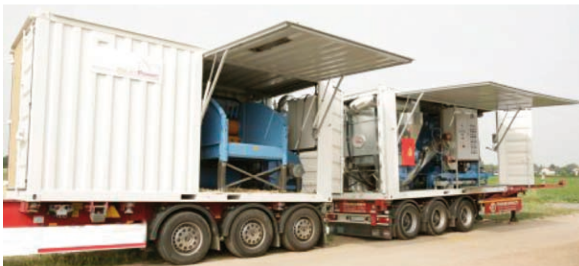
Abbildung 3-2: Mobil einsetzbare HIMEL-Pelletiermaschine (Quelle: Hirlinger 2010)
